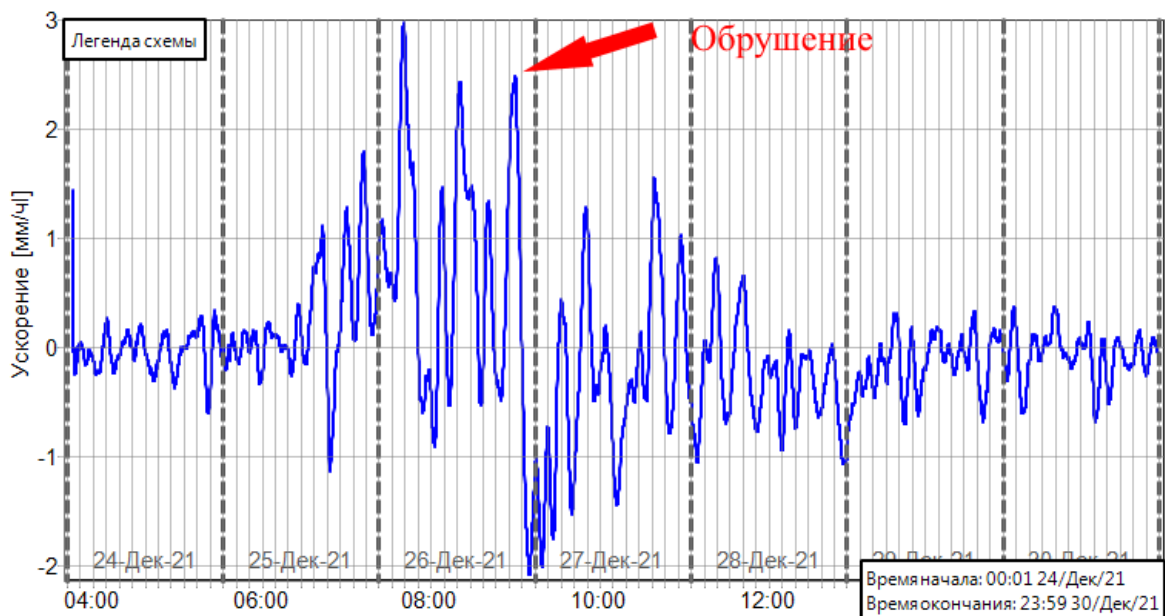
Рисунок 2.21 – График ускорения скорости смещения при обрушении №17 в таблице 2.1
