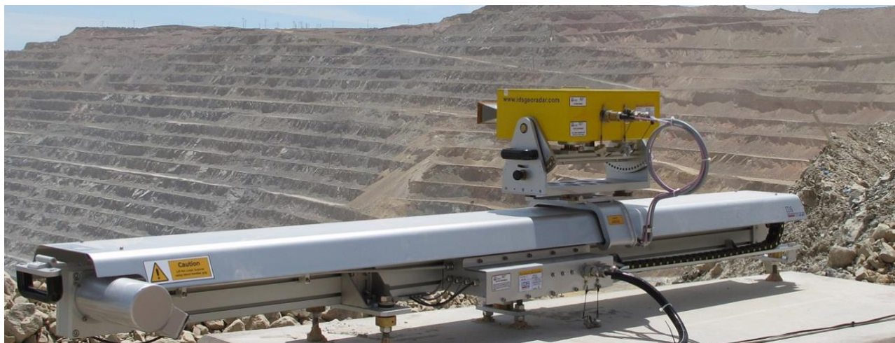
Рисунок 2.6 - Радар IBIS-FM с синтезированной апертурой [94]
