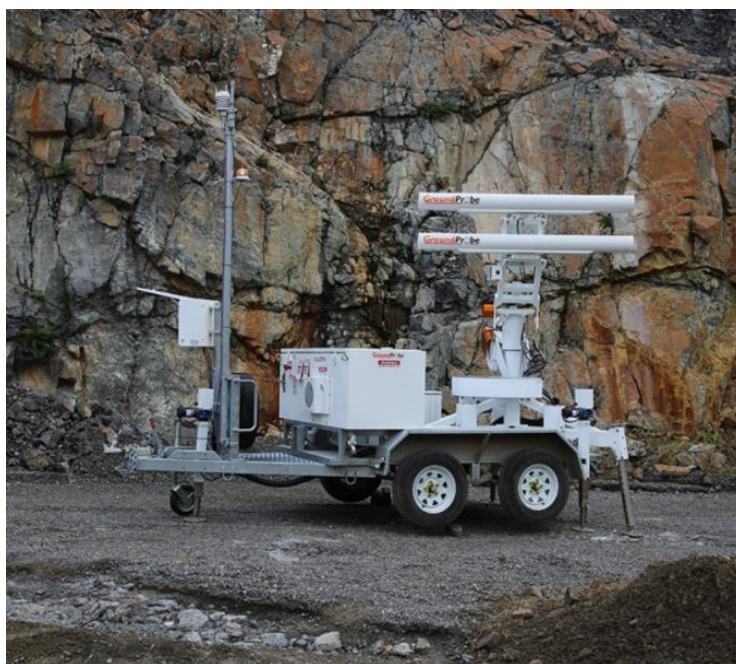
Рисунок 2.5 - 2D-радар с реальной апертурой SSR-FX [93]
