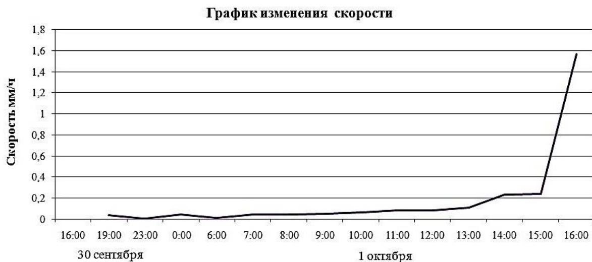
Рисунок 4.1 - График рассчитанной скорости смещения массива при обрушении №21
