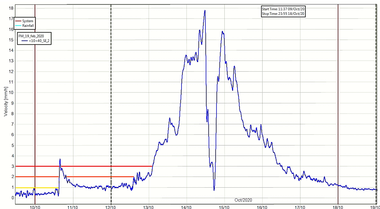
Рисунок 4.7 – График скорости смещения массива горных пород №5 (от 14.10.2020) с выставленным критическим значением
