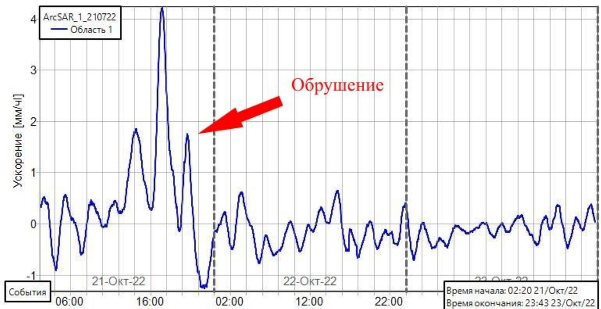
Рисунок 2.19 – График ускорения скорости смещения при обрушении №10 в таблице 2.1
