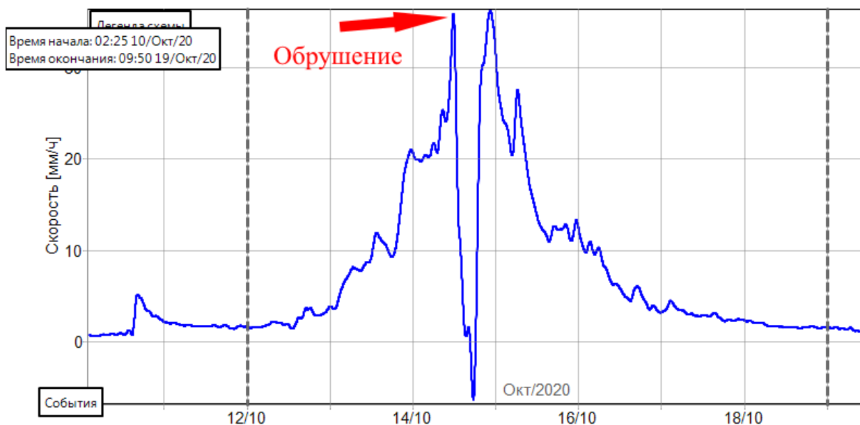
Рисунок 2.16 – График скорости смещения при обрушении №5 в таблице 2.1
