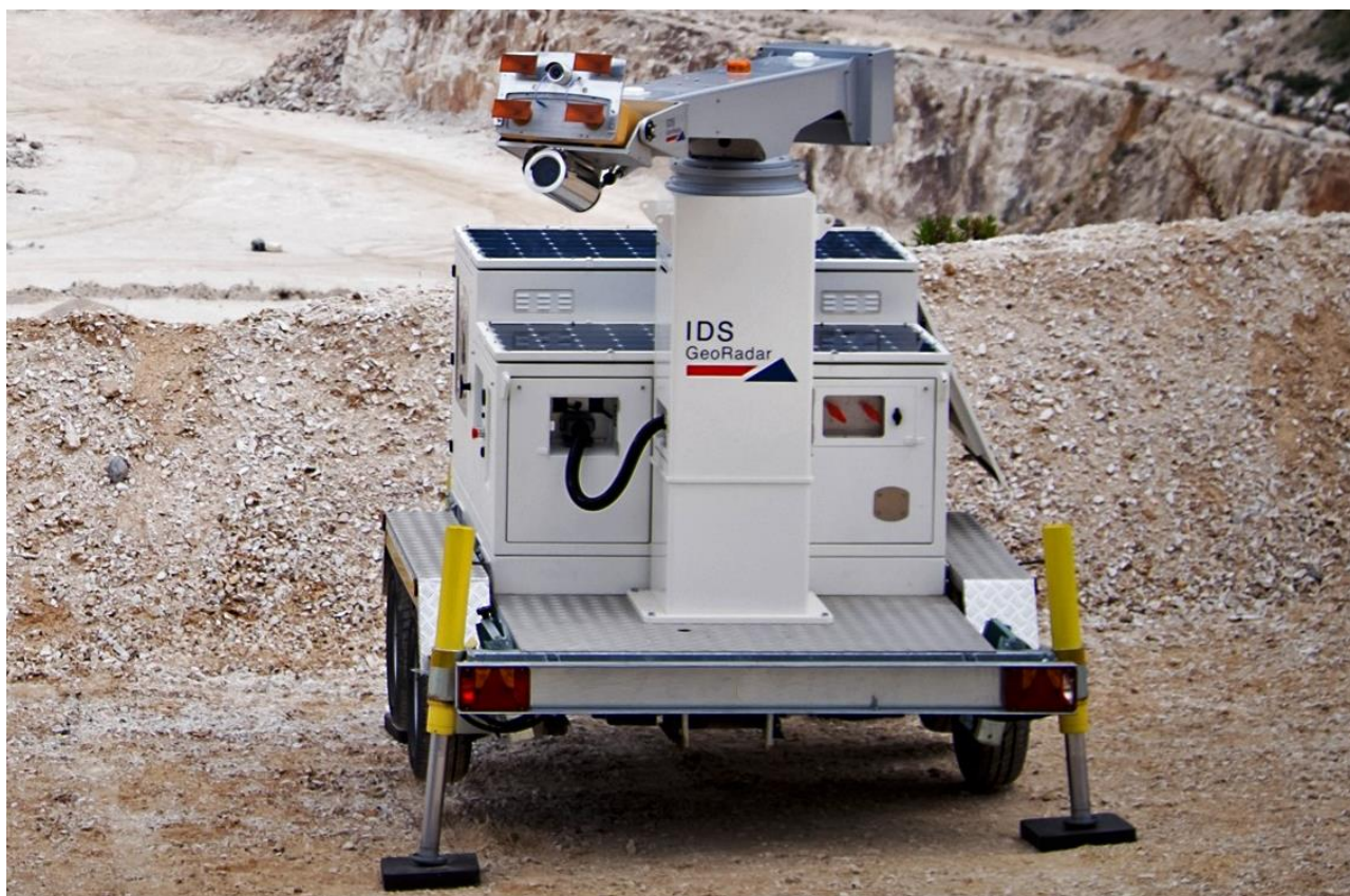
Рисунок 2.7 - Радар IBIS ArcSAR с синтезированной апертурой [94]
