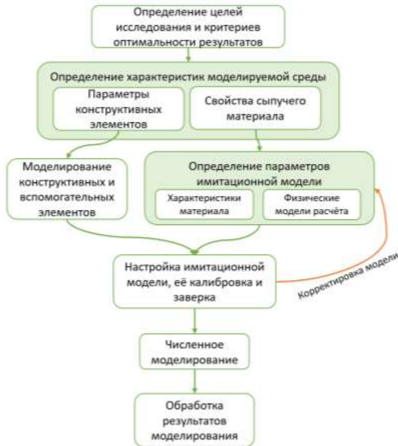
Рисунок 2.15 – Принципиальная блок-схема методики имитационного моделирования выпуска руды
