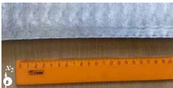
Рис.2. Установки непрерывного литья и деформации металла : а – вертикального типа (внешний вид рабочей клетки); б – горизонтального типа (общий вид); в – экспериментальный образец, полученный на установке вертикального типа; г – экспериментальный образец, полученный на установке горизонтального типа.
