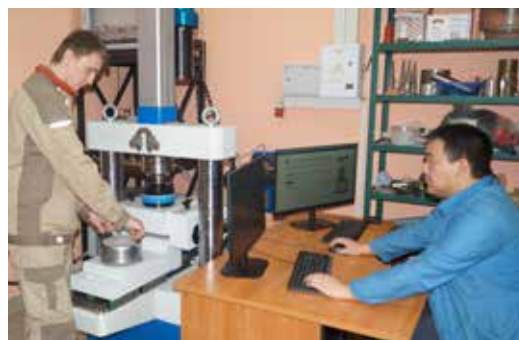
Измерение образцов горных пород для определения на срез на установке ГТ 1.2.12. (и.с. Рассказов М.И.)
