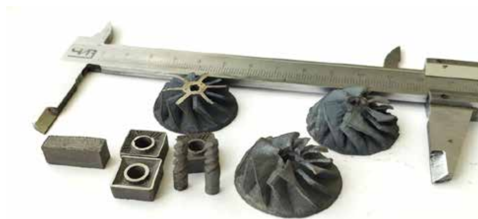
Образцы металлокерамических изделий простой и сложной формы, полученные по предложенной методике в результате поисковых экспериментов.
