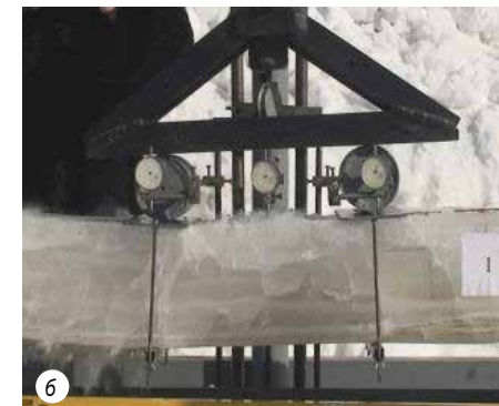
Рис.9. Методика испытания образцов армированного льда, при различных стадиях нагружения: а – начальная стадия; б – полное разрушение.
