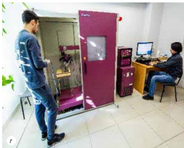
Рис. 1. Проводимые исследования на имеющемся оборудовании: а – электронный растровый микроскоп Zeiss EVO MA-10; б – универсальная испытательная машина Shimadzu AGX-250kN; в – энергодисперсионный рентгенофлуоресцентный спектрометр Shimadzu EDX-8000; г – рентгеновский анализатор напряжений Rigaku MSF-3M.
