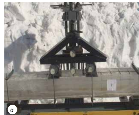
Рис.9. Методика испытания образцов армированного льда, при различных стадиях нагружения: а – начальная стадия; б – полное разрушение.
