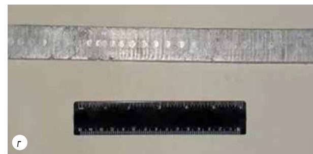
Рис.2. Установки непрерывного литья и деформации металла : а – вертикального типа (внешний вид рабочей клетки); б – горизонтального типа (общий вид); в – экспериментальный образец, полученный на установке вертикального типа; г – экспериментальный образец, полученный на установке горизонтального типа.
