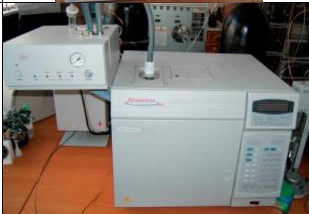
**Анализатор общего углерода/азота
