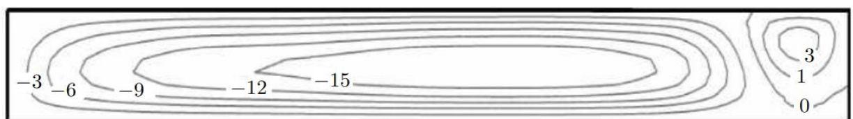
Рисунок 3.8 – Сравнение расчетных V (а) и экспериментальных V_{\text{exp}} (б) полей скорости в створе 145^\circ в [см/с]
