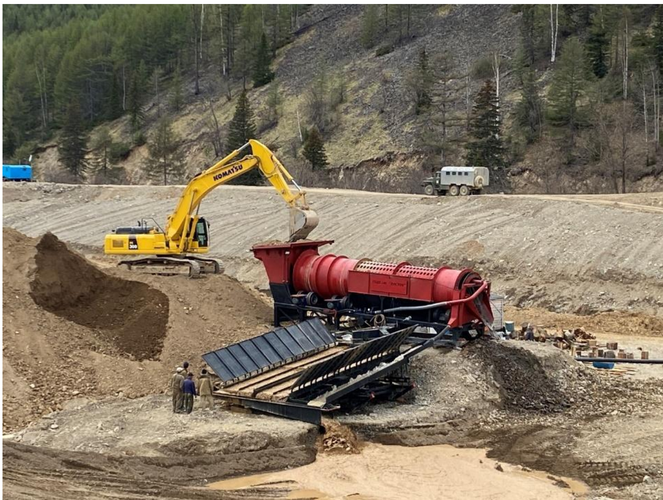
Рисунок 3.1 – Промывочный прибор ПБШ-100 на месторождении руч. Хребтовый, Хабаровского края
