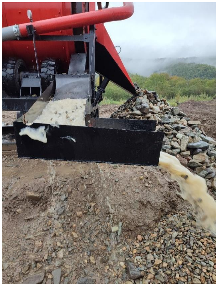
Рисунок 3.4 – Шлюз-самородкоуловитель промприбора ПБШ-100
