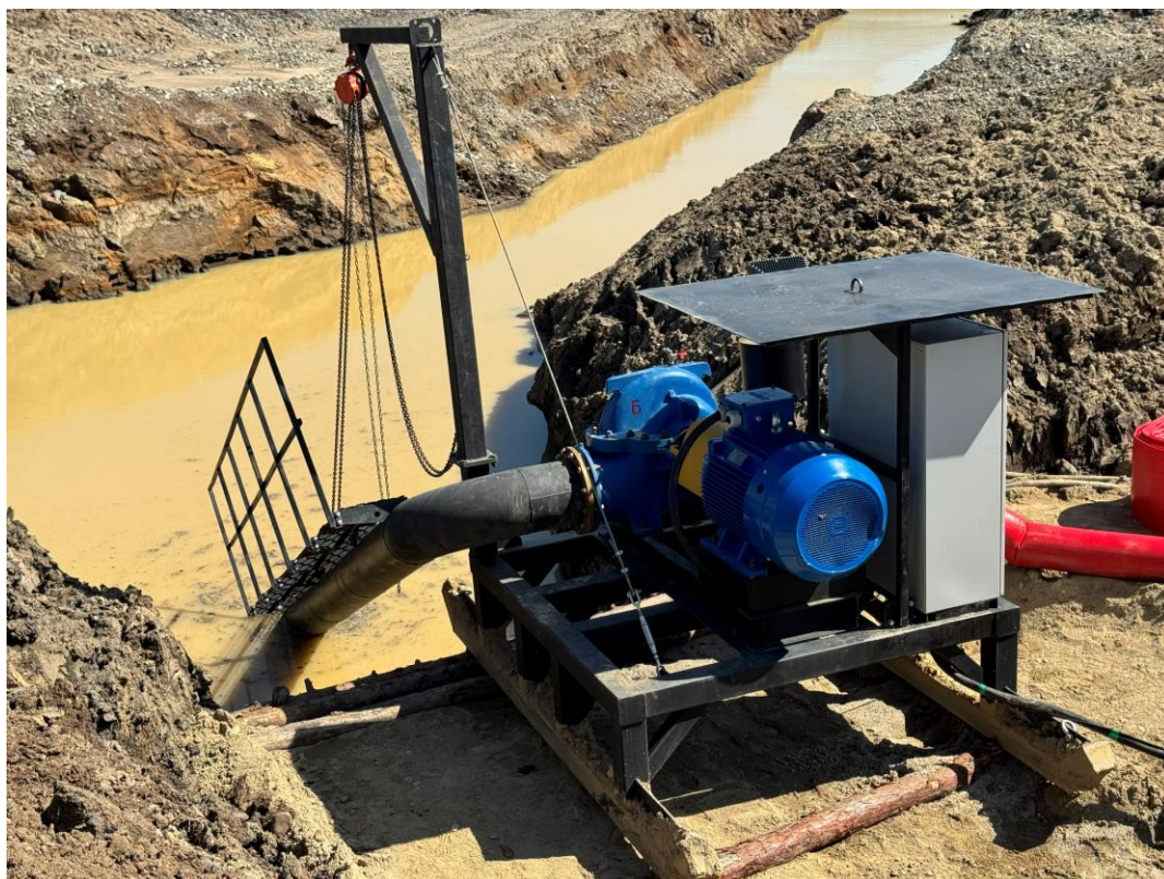
Рисунок 3.5 – Насосная установка 1Д800-56Б
