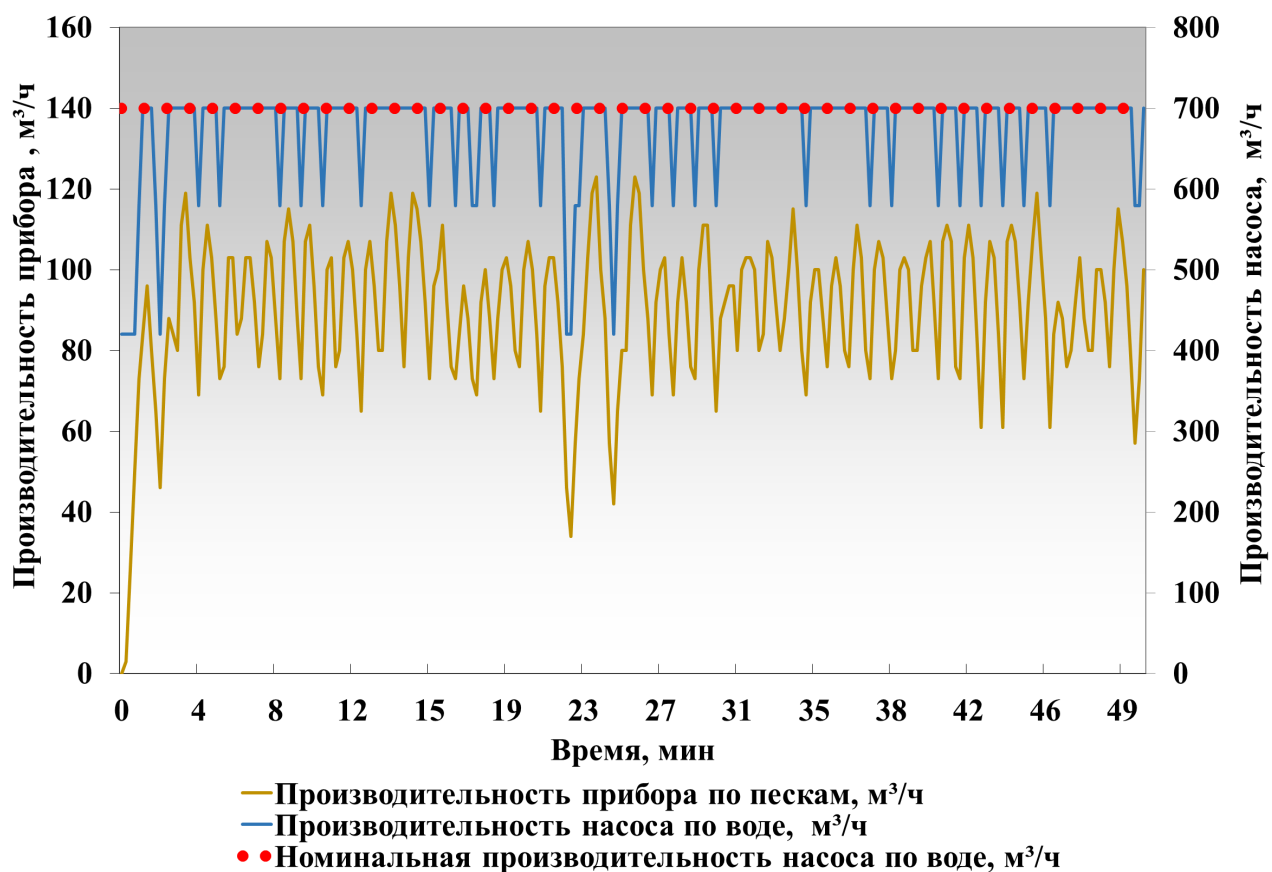
Рисунок 2.19 - Динамика подачи песков и воды насосом 1Д 800-56Б - 110 кВт
