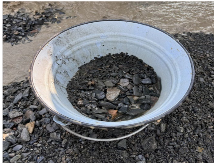
Рисунок 2.15 - Твердый остаток в пульпе на сливе ГИТ-52
