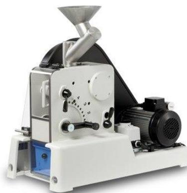
21.2 Дисковая мельница PULVERISETTE 13 предназначена для тонкого измельчения твердо-хрупких и среднетвердых материалов также в непрерывном режиме работы.
