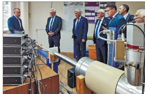
В Институте тектоники и геофизики им. Ю.А. Косыгина ДВО РАН находится единственный на Дальнем Востоке прибор – криогенный магнитометр, предназначенный для измерения остаточной намагниченности образцов горных пород. Он позволяет определить, где образовалась горная порода много миллионов лет назад
