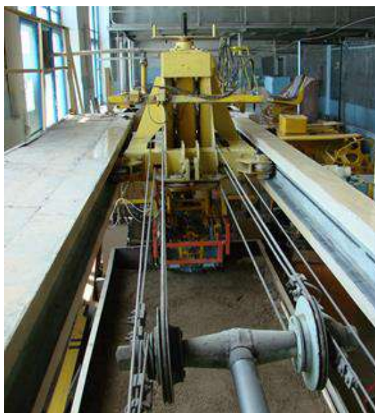
Рисунок 5.14 – Экспериментальный стенд для копания грунтов в лабораторных условиях
