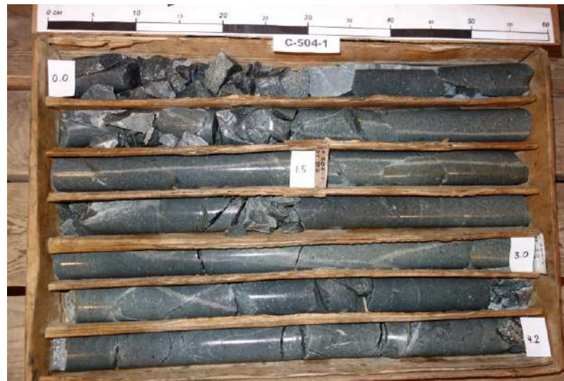
Рисунок 3.29 – Керны отобранные при бурении скважины С 504-1 из полевого штрека для подсечения рудных тел на месторождении Пионер
