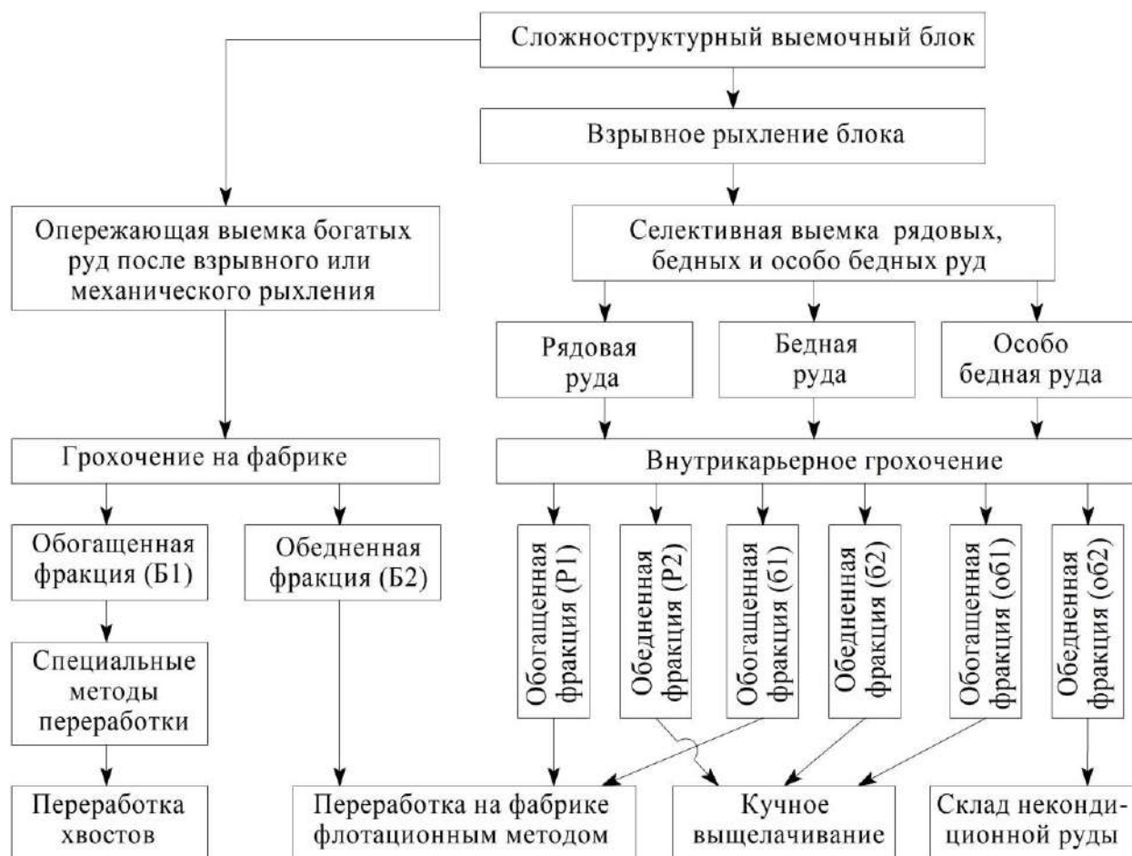
Рисунок 2.4 – Схема формирования рудопотоков при отработке сложноструктурного блока, для руд которого характерно фракционирование по классам крупности с существенно различающимся содержанием полезного компонента
