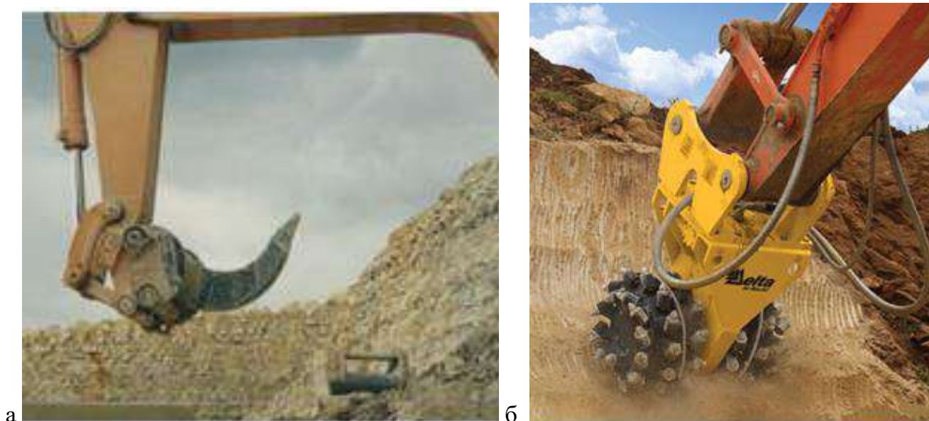
а – рыхлитель (риппер); б – навесная фреза
