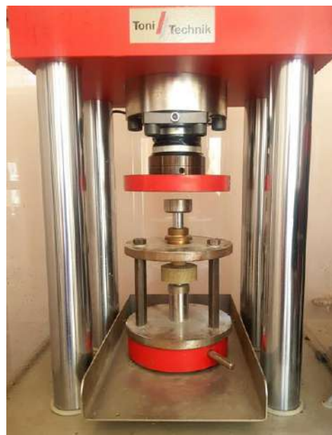
Рисунок 3.23 – Размещение образца между сферическими инденторами испытательной машины ToniNORM
