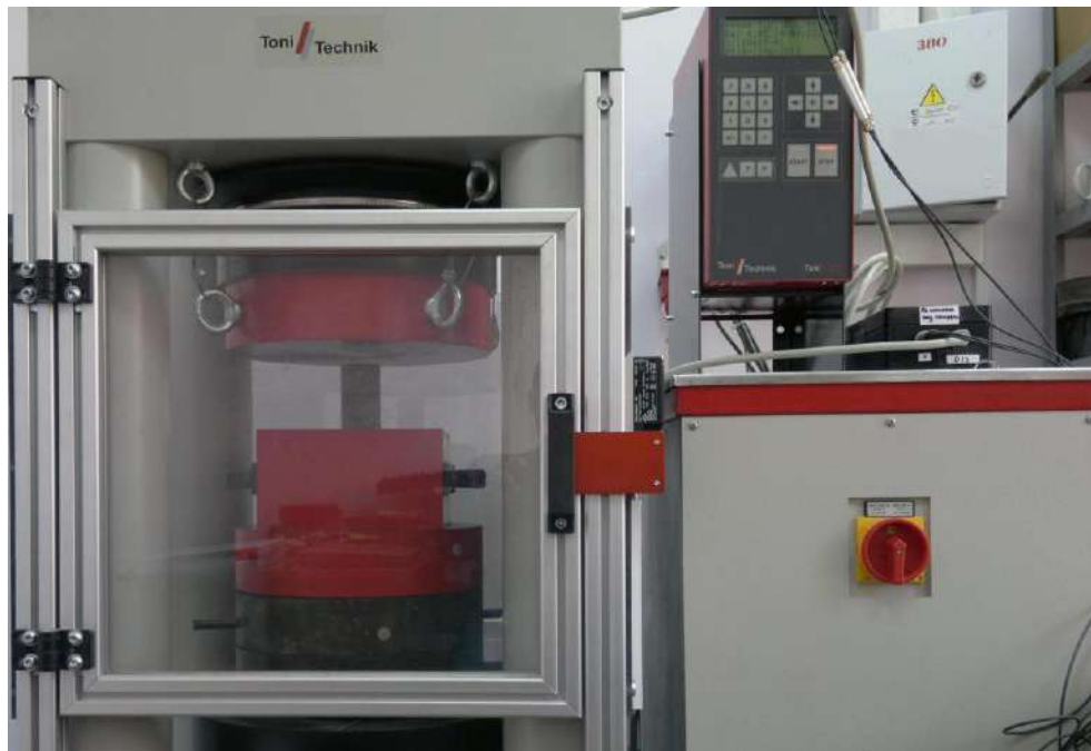
Рисунок 3.22 – Размещение образца между плитами испытательной машины ToniPACT II
