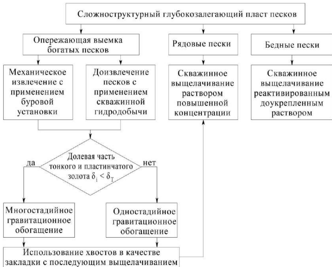
Рисунок 2.7 – Блок-схема адаптивной технологии разработки сложноструктурного глубокозалегающего пласта
