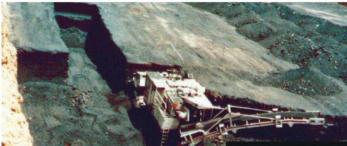
Рисунок 1.19 – Стреловой карьерный комбайн фирмы Voest-Alpine
