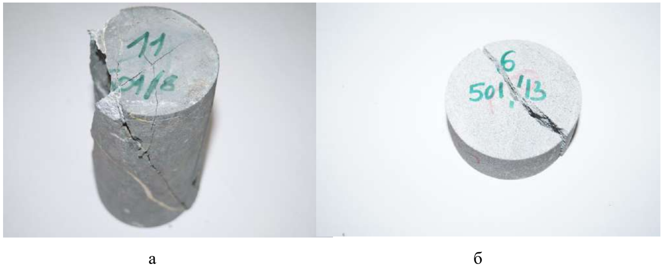
а – при одноосном сжатии; б – при одноосном растяжении
