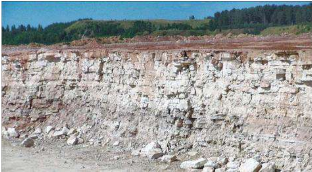
Рисунок 4.5 – Вид на верхний доломитовый уступ, обрабатываемый комбайном со стороны кровли [219]
