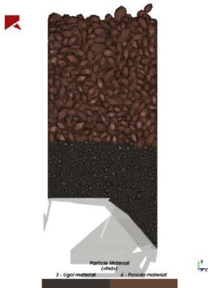
Рисунок 3.21 – Пример генерации многогранных частиц засыпкой
