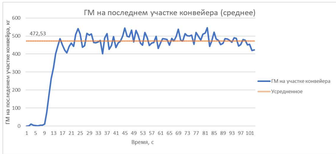
Рисунок 5.6 – График массы ГМ на последнем участке конвейера для первого варианта волнового режима
