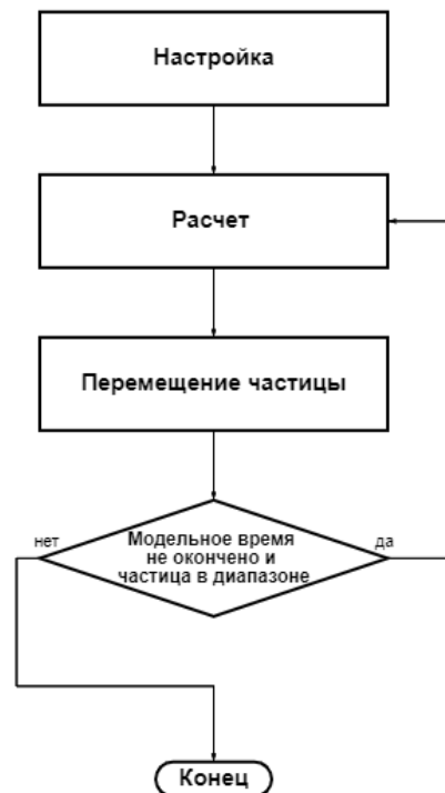
Рисунок 2.3 – Схематичный алгоритм работы Rocky DEM
