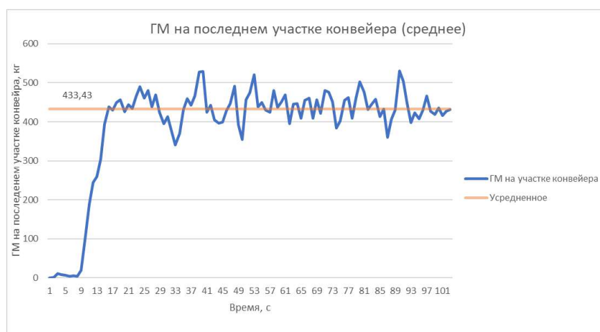
Рисунок 8 – График массы ГМ на последнем участке конвейера для второго варианта волнового режима
