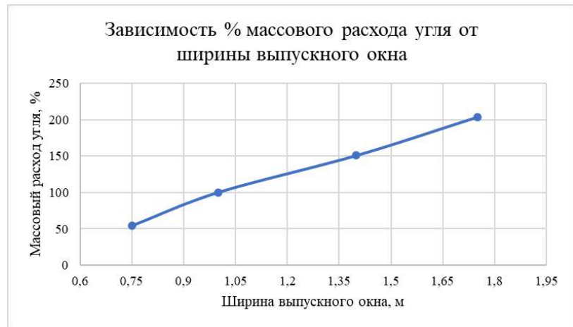
Рисунок 3.30 – График зависимости % массового расхода угля от ширины выпускного окна (за 100% взято значение массового расхода угля при ширине ВО 1 м)
