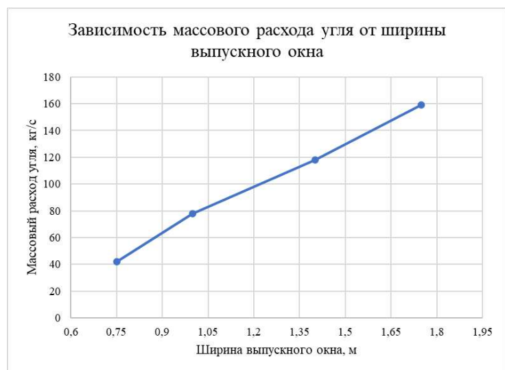
Рисунок 3.29 – График зависимости массового расхода угля от ширины выпускного окна
