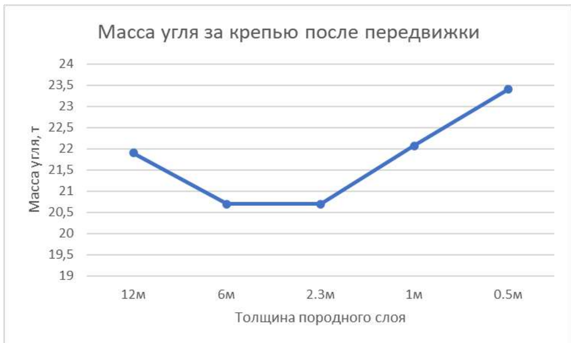
Рисунок 3.50 – График изменения массы угля за крепью после передвижки в зависимости от толщины породного слоя
