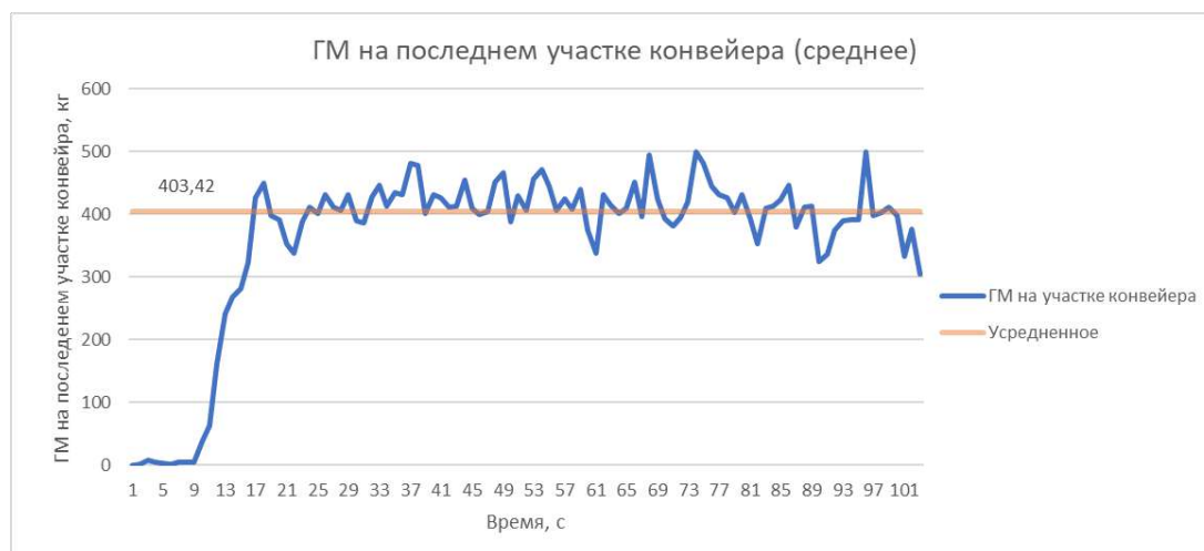
Рисунок 5.15– График массы ГМ на последнем участке конвейера для четвертого варианта волнового режима
