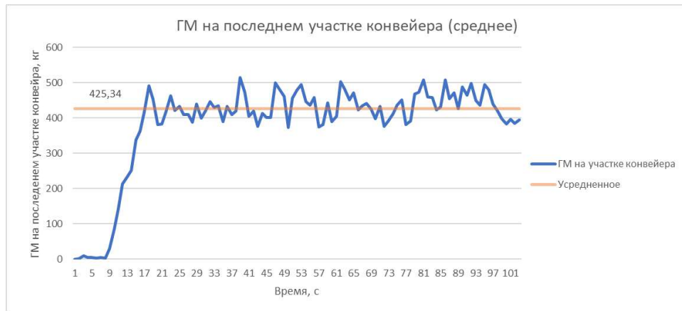
Рисунок 5.12 – График массы ГМ на последнем участке конвейера для третьего варианта волнового режима
