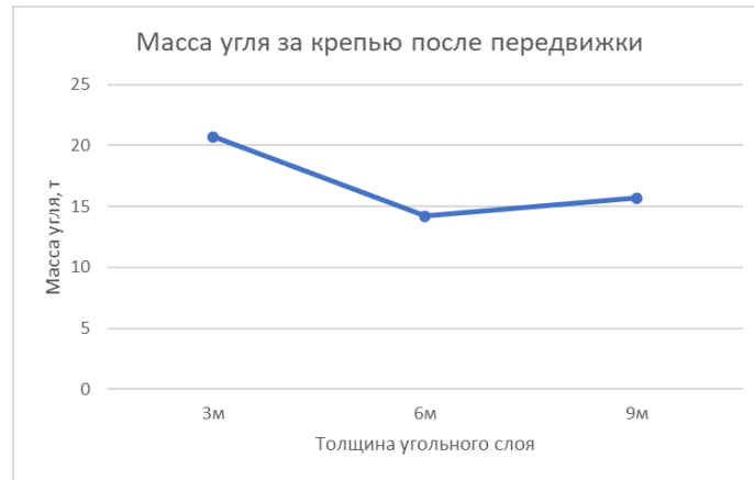
Рисунок 3.63 – График изменения массы за крепью после передвижки в зависимости от толщины породного слоя
