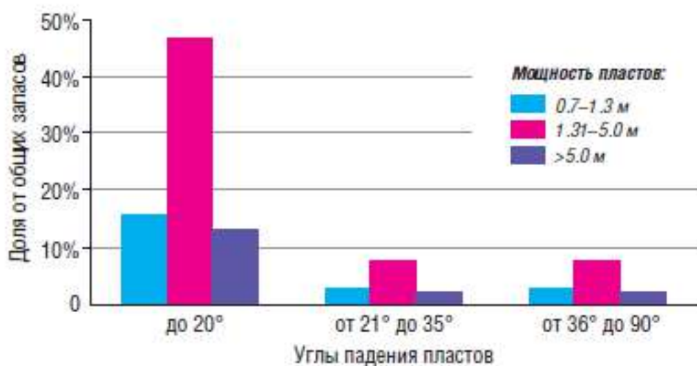
Рисунок 1.3 – Распределение балансовых запасов углей Кузбасса по углам падения и мощности пластов [2]
