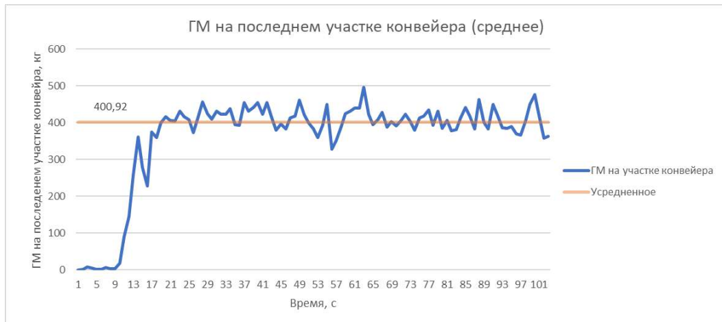
Рисунок 5.18 – График массы ГМ на последнем участке конвейера для пятого варианта волнового режима
