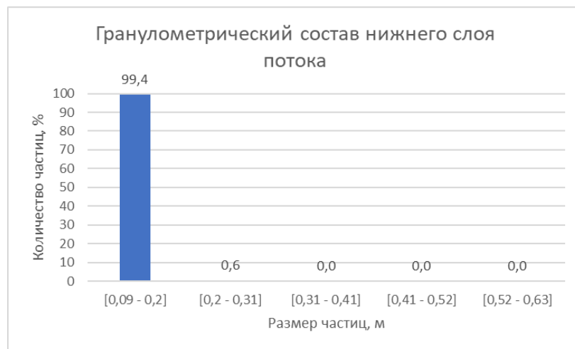
Рисунок 7– Гранулометрический состав нижнего слоя потока ГМ
