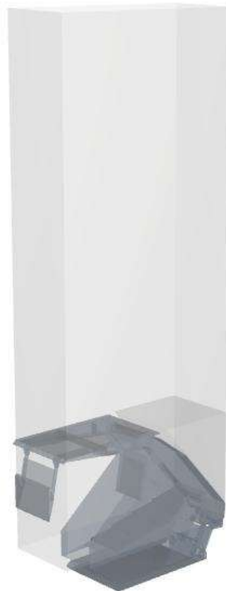
Рисунок 3.6 – 3D-модель расположения вспомогательной конструкции относительно крепи для поддержания горной массы
